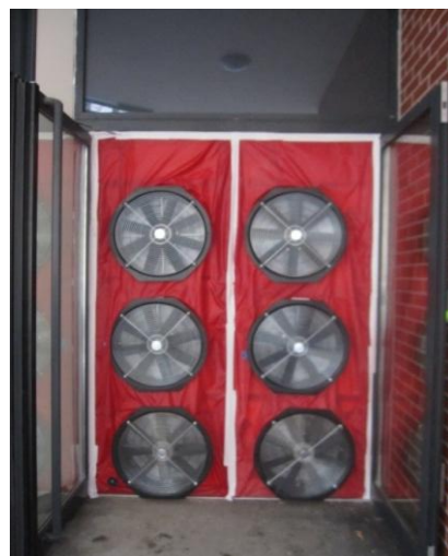
MONTAGE Multi ventilateurs
